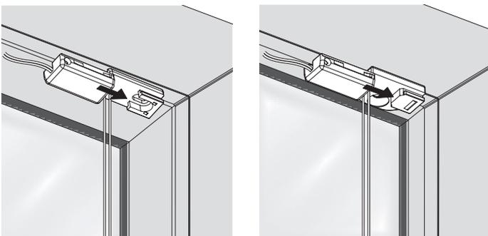
Die **unteren Spannschuhe** aus der Schiene nehmen und auf die unten montierten Halteplättchen schieben, bis sie einrasten.
