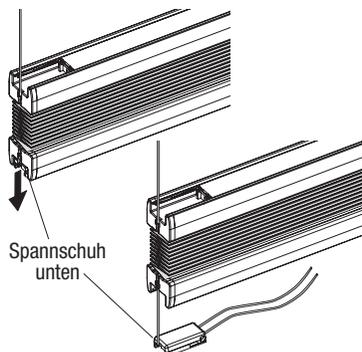
Gespannte Plissee-Anlage schließt bzw. öffnet durch Verschieben des Bediengriffes.
