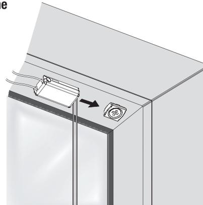
Die unteren Spannschuhe aus der Schiene nehmen und auf die unten montierten Halteplättchen schieben, bis sie einrasten.
